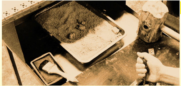
Reihenklemmen aus Porzellan, mit der Hammerpresse hergestellt: Manuelles Abfüllen von Nassgranulat (Privatsammlung) Trocknen von Elektroporzellan nach dem Pressen (Privatsammlung)
