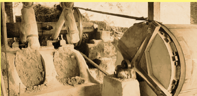
Herkömmliche Produktionsmaschinen ((水碓 shui dui) zur Erzeugung von Pulvern für die Herstellung von Elektroporzellan (Privatsammlung))
