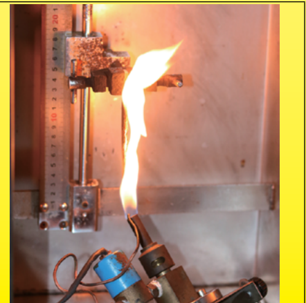
Prüflinge während der Prüfung laut UL94 V-0
