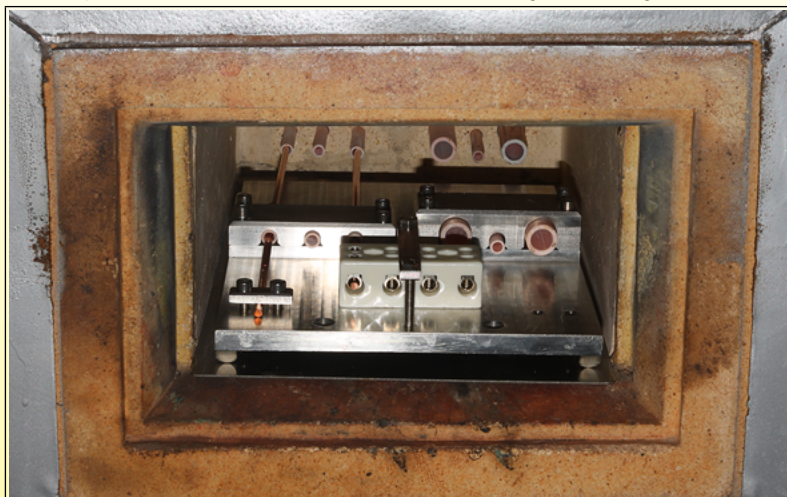
Prüfen für den spezifischen Widerstand von Keramik in Abhängigkeit von der Temperatur (Ultimheat Labor)
