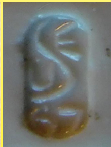
1932 USE-Kennzeichnung auf Maure-Reihenklemmen aus Porzellan
